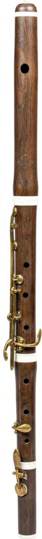
Flûte traversière en ré réalisée par Jean-François Martin (1794-1876). Ébène, 5 viroles en os (?), 6 clés rondes en laiton, montées sur boules fixées sur des patins, après 1827. Le Musée des instruments à vent, La Couture-Boussey. Inv. 30. © MIV / cliché Emanuele Marconi
